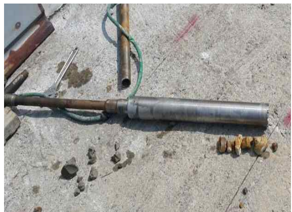
SPAN 9 TYPE3 자치센터 구간 지반 상태 확인
